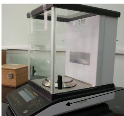
Рисунок 3 – Обозначение места нанесения знака поверки весов
